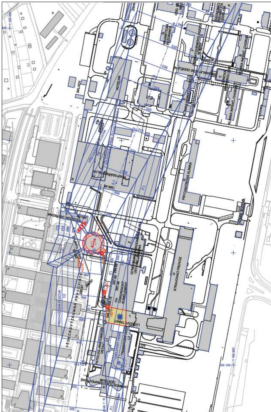
Obr. 2 Vzdušný prostor heliportu potřebný pro zajištění bezpečného provozu
